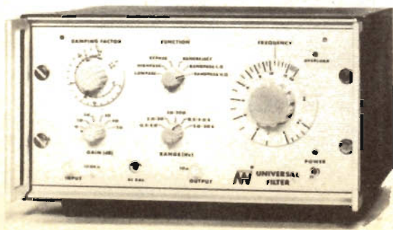
Filtro universale Nortronic: simulatore di carichi passivi, molto utile in laboratorio.
