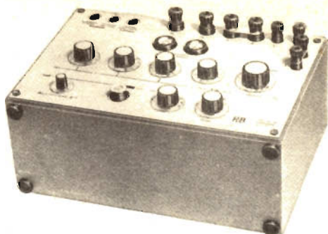
Ponte di Schering classico e ponte di misura per il calcolo del fattore di perdita dei condensatori. Sono gioielli da laboratorio peraltro di limitata utilità per lo sperimentatore.
